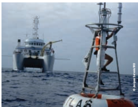
Mouillage équatorial avec mât de transmission de données vers les satellites (profondeur des océans en temps-réel) - Pirata
