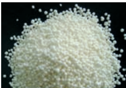
Substance dangereuse : stock d'ammonitrate inflammable.
