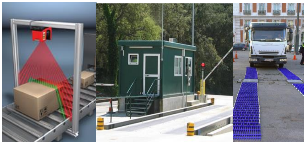
Figura 1-34. Sistema de control de galibo y peso.
