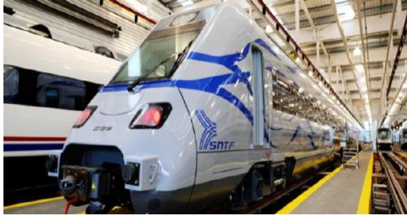
Tren Regional Diésel, con Sistema Inteligente de Basculación Integral (SIBI) y Mecanismo BRAVA
