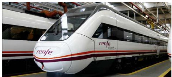
Tren de Alta Velocidad S/121 con Bogie de Rodadura de Ancho Variable (BRAVA)
