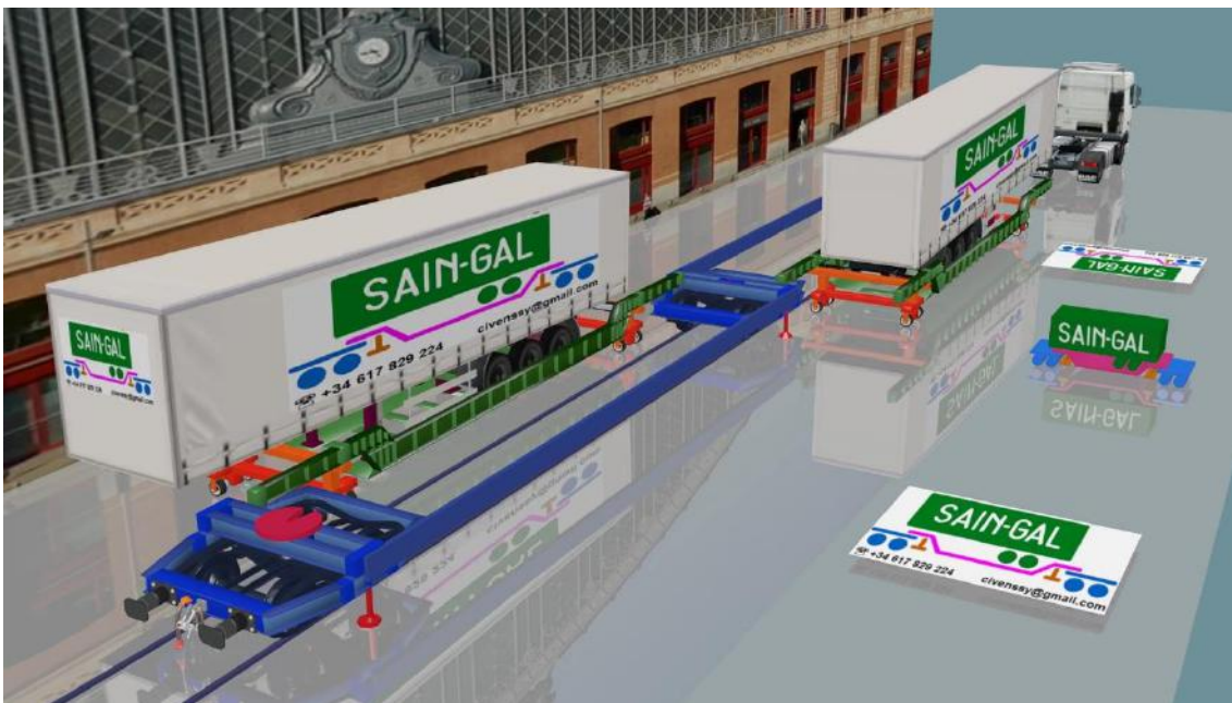
Figura 1-5. Separación cabezas tractoras.
