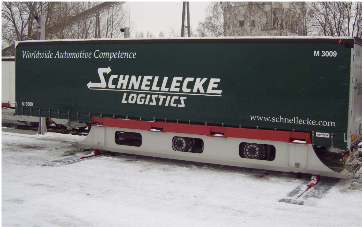
Figura 3-13 Dispositivo de vagón cargado JMWA sobre barra lanzadera "GMSB" en el GateModulo CargoBeamer (variante del prototipo en Leipzig)
