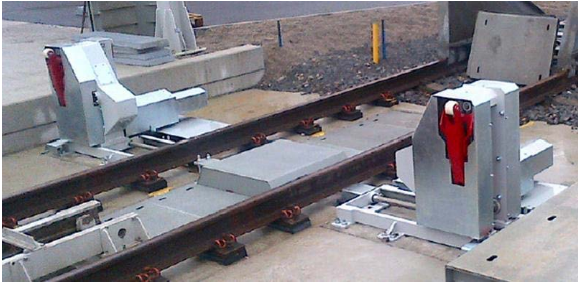
Figura 3-11 Accionamiento de pared lateral "GMAS" en el GateModule de CargoBeamer
