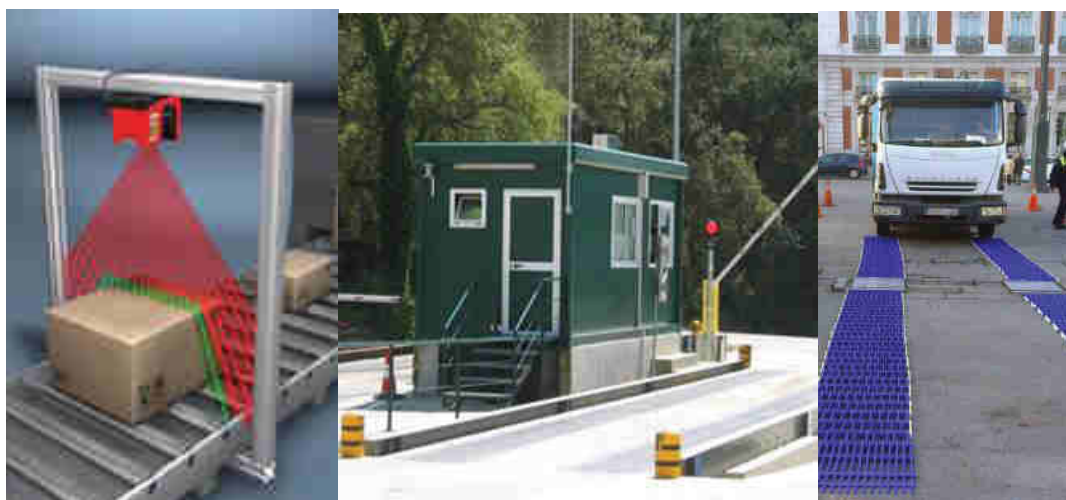
Figure 1-34. Un système de contrôle de gabarit et de poids.
