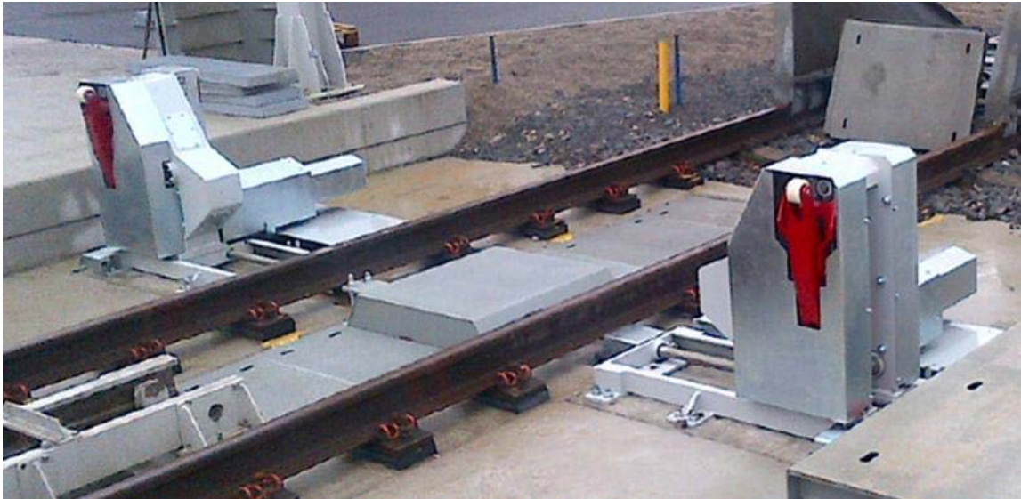
Illustration 3-11 Moteur de paroi latérale « GMAS » dans le module terminal CargoBeamer
