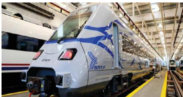
Train régional diesel, avec Système Intelligent de Basculement Intégré (SIBI) et Mécanisme BRAVA
