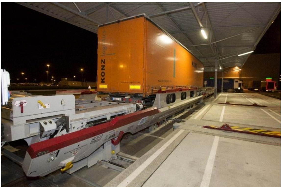
Illustration 3-12 Pivotage de la paroi latérale avec module « GMAS » actif
