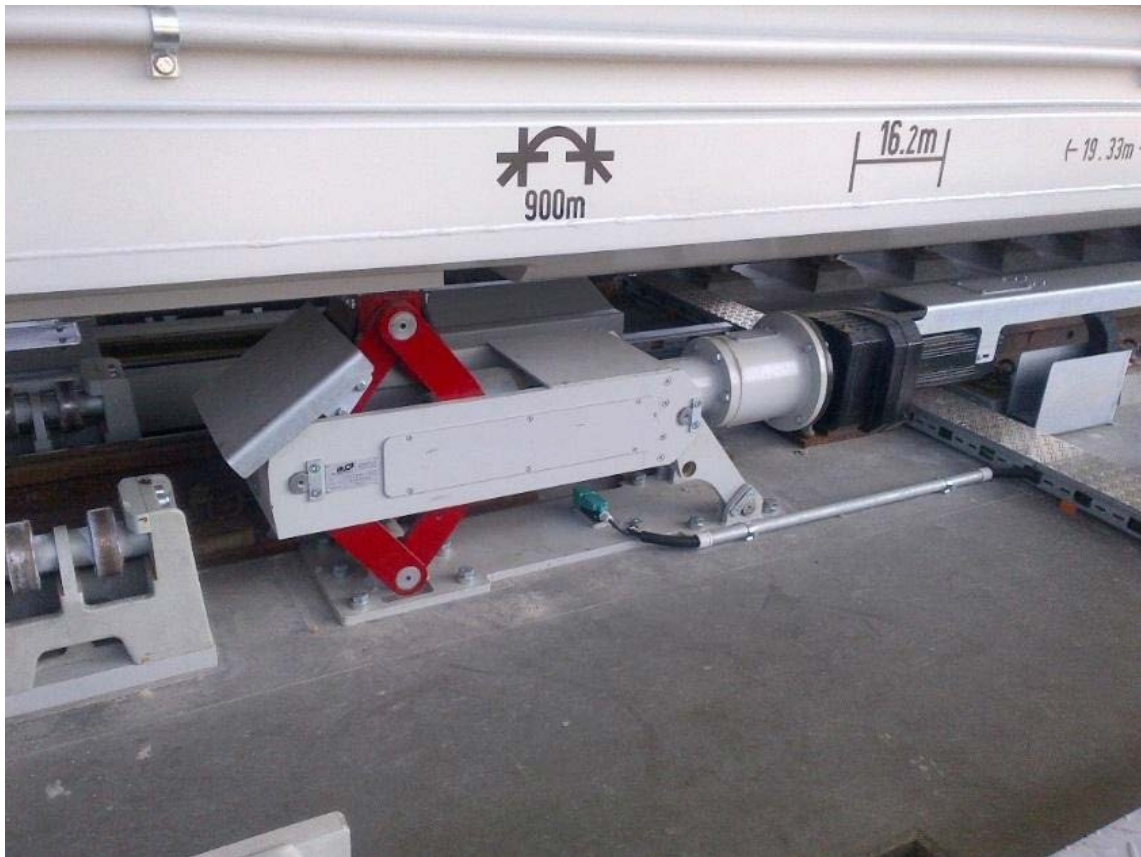
Illustration 3-15 Système de levage à quai « GMHV »
