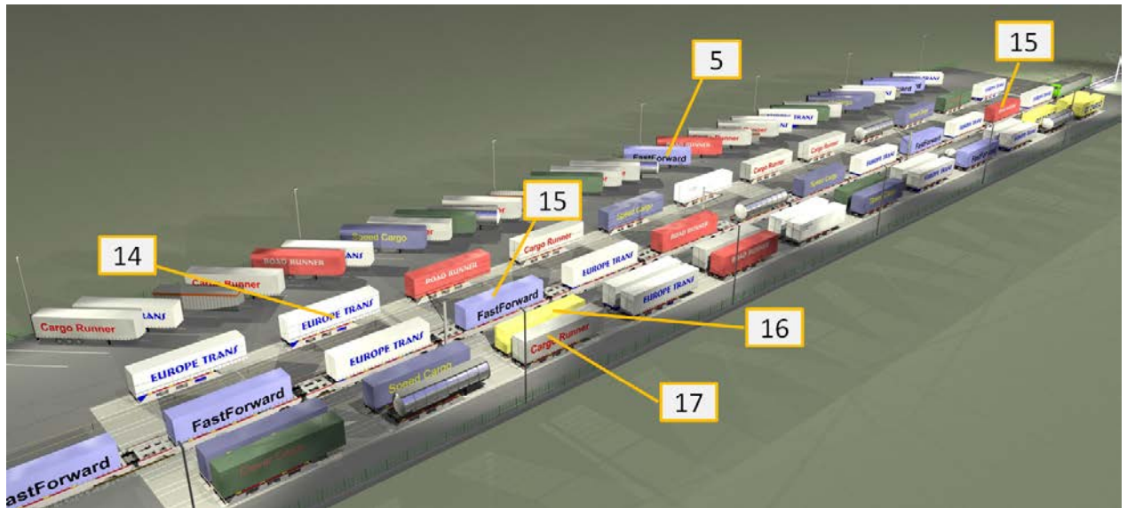
Illustration 3-8 Phase de transbordement dans un terminal CargoBeamer
