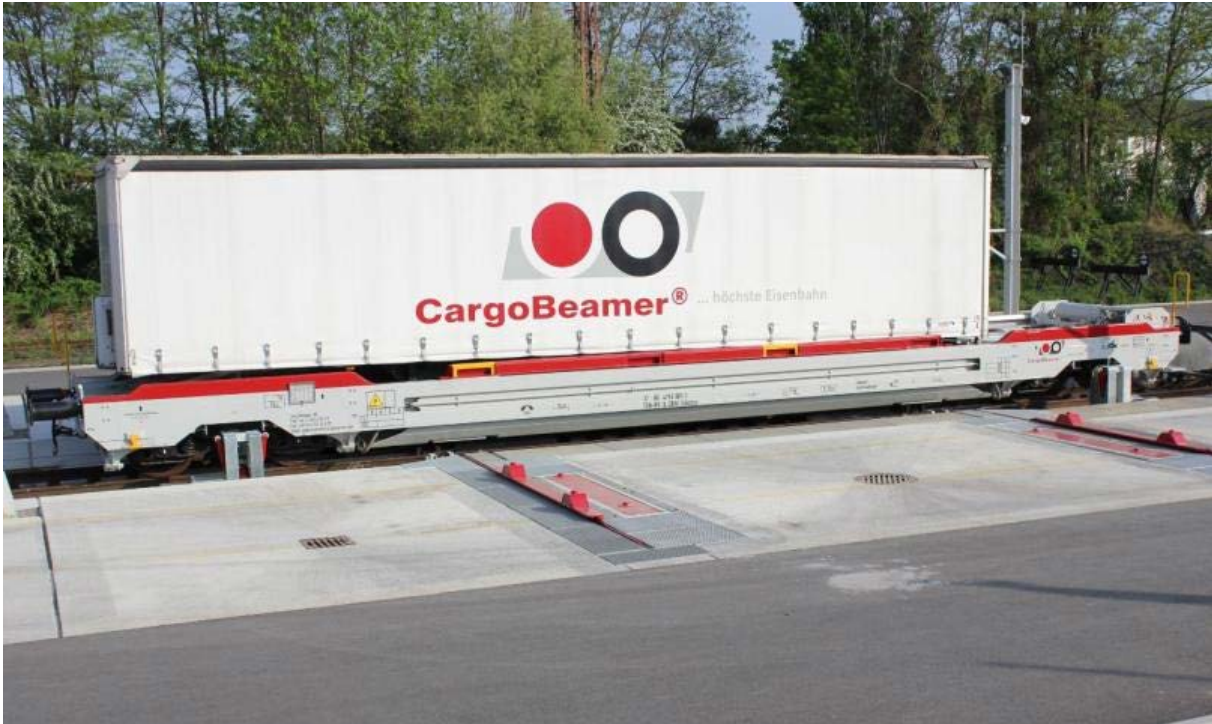
Illustration 3-2 Module – terminal (« Module terminal »), semi-remorque dans le wagon
