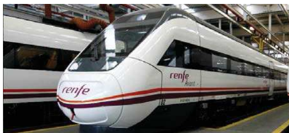
Train Grande Vitesse S/121 avec Bogie de Roulement à Écartement Variable (BRAVA)
