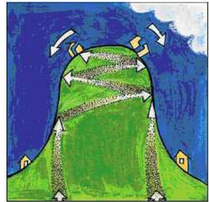
Figure 5-1- Effet topographique en sommet (extrait guide PPR Risques sismiques 2002 – source Laurence Barret)
