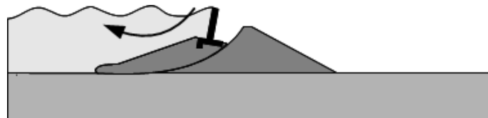
Figure 2.14 : Glissement superficiel affectant un ouvrage en crête (Traduit et adapté de l'ILH)
