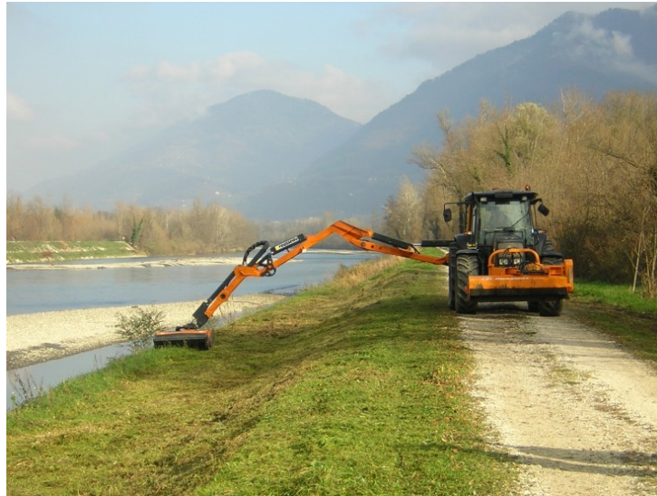
Illustration 4 : Tracteur équipé d'une épaveuse - ADIDR
