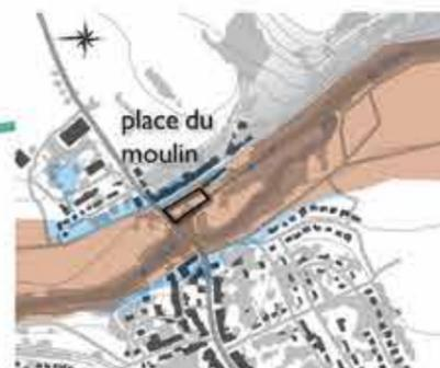
Dans le plan de zonage du Plan de Prévention des Risques d'Inondation de l'Orne, la place est située dans la zone d'aléa maximal en rouge
