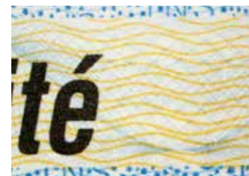
Les zones permettant l'inscription de la date, de validité, de la numérotation et de l'autorité de délivrance sont constituées de guillochis bleus et jaunes (offset)
