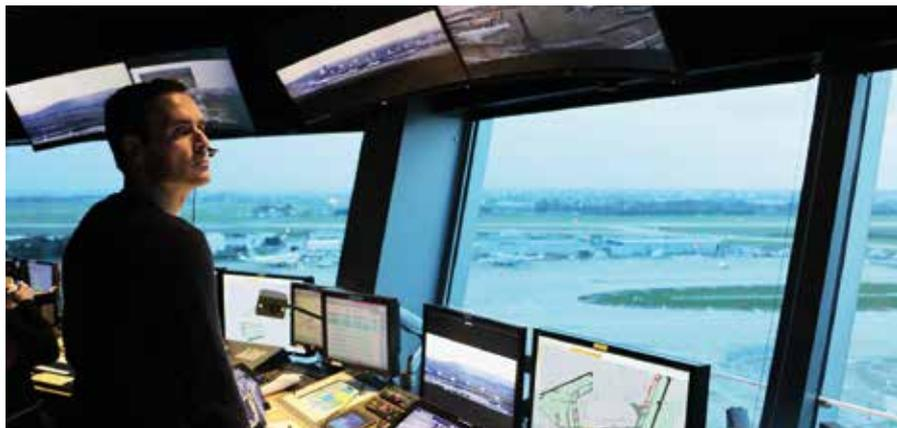
Vigie provisoire à Orly : écrans haute définition de surveillance des mouvements au sol.
