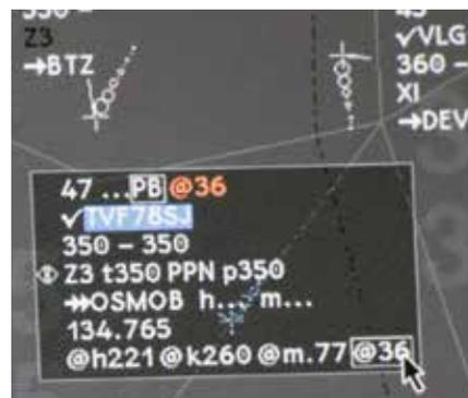
Surveillance enrichie : le contrôleur dispose des paramètres du vol en temps réel.
