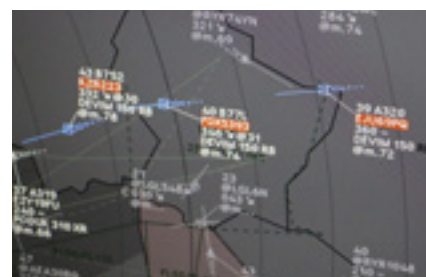
Extended TMA : vols à l'arrivée par le Nord-Est à destination de Paris-CDG séquencés très en amont par le CRNA Nord en collaboration avec les centres adjacents et le Network Manager .
