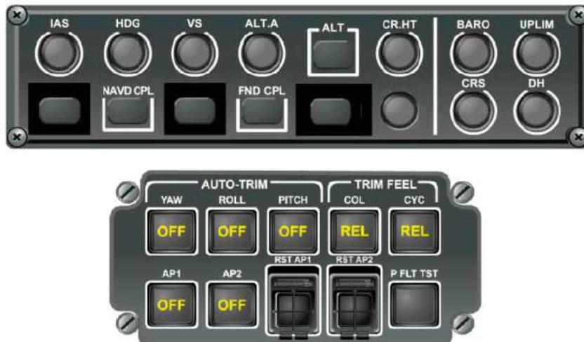
**Le pilote automatique dit 4 axes offre un mode de stabilisation de base sur les axes de tangage, de roulis, de lacet et collectif.**
