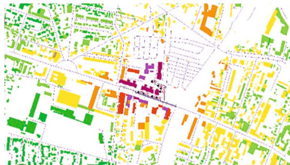
Figure 2 : niveaux sonores en façade des bâtiments
